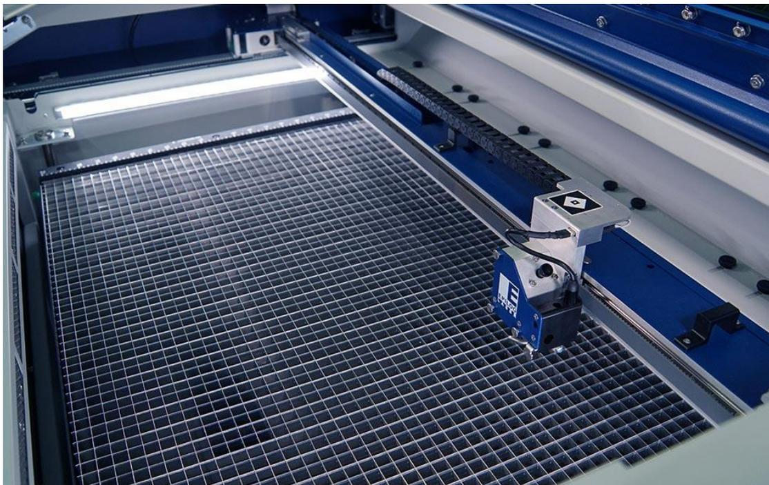
Questo tipo di sistema ha una tenuta di messa a fuoco di qualche millimetro, ciò permette di poter effettuare marcature anche su oggetti leggermente curvi, per la lavorazione a 360° però è necessario il rotary, un accessorio da posizionare nel piano macchina che si occuperà di far ruotare l'oggetto sotto il raggio laser.
